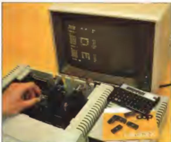
L'Apple-compatible utilizzato per la lettura e la programmazione con della EPROM. Sul monitor lo scriviamo con chi è presente in memoria, nella memoria è installata la scheda di programmazione, sul drive la MPIC installata per la ricezione dei dati.
